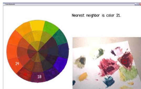
Fig. 2. Interaktionsdialogfenster im Farbmischmodus mit automatischer Erkennung und Lokalisierung der Farben der Mischpalette. Das Farbrad ist links abgebildet, das Kamerabild der Farbmischpalette mit der Farbselektion des Künstlers rechts. [5]
