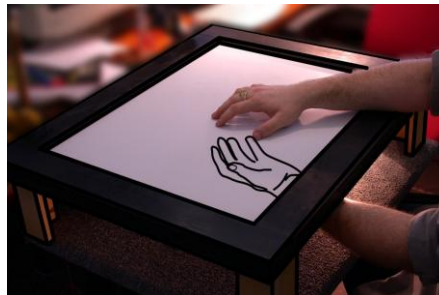
Abb. 1. Ein zweiseitiger Touch-Table. Die gezeichnete, eigentlich nicht sichtbare Hand wurde hinzugefügt, um die Benutzung der unteren Eingabefläche zu verdeutlichen. [1]
